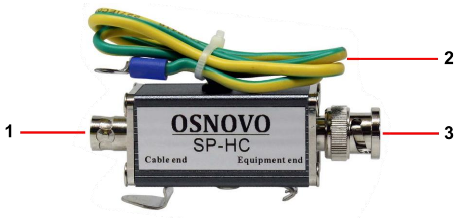
Рис. 3 Устройство грозозащиты SP-HC, разъемы
