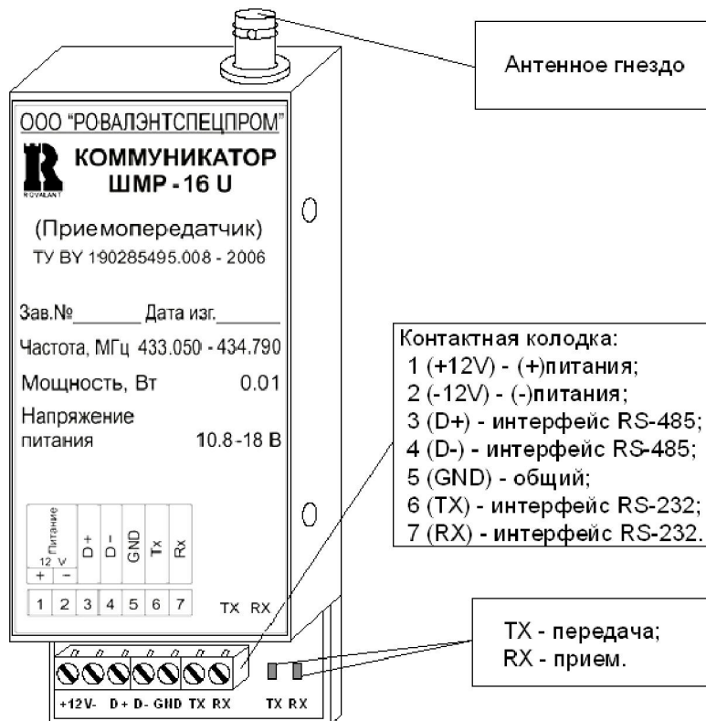
Рисунок 33 - Внешний вид коммуникатора ШМР-16U
